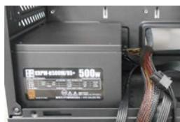
ファンを下向きに取り付けます。VR-002 のマザーボード用 8ピンをケースの裏側を通す場合は、延長ケーブルを使用して下さい。
