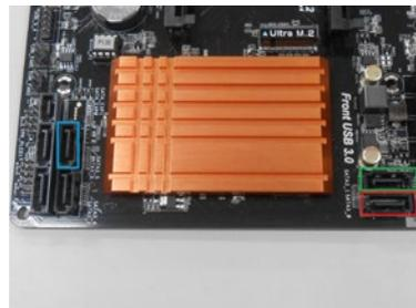
HDD/SSD は SATA3\_0 (赤枠)、光学ドライブは SATA3\_5 (青枠) に接続します。HDD や SSD を 2 台搭載する場合は、起動用ドライブを赤枠、2 台目のドライブは ATA3\_1 (緑枠) に接続します。
