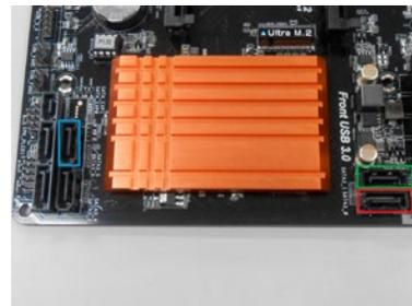
HDD/SSD は SATA3\_0 (赤枠)、光学ドライブは SATA3\_5 (青枠) に接続します。
