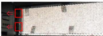
Fulmo.Q PLUS の場合は、2カ所のロックを矢印方向に押ししながら、ベゼルを外側から内側に押し込んで下さい。
