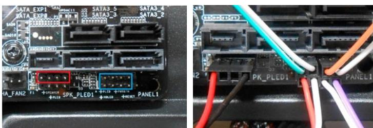
赤枠部分に BEEP スピーカーを、青枠部分にフロントパネル用ケーブルを配線します。BEEP は赤い線を左側、フロントパネル用は写真の通りに接続して下さい。
