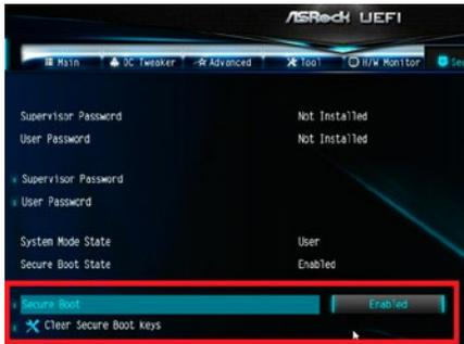
「Security」タブの「Secure Boot」を「Enable」にすると、下に Key 状態が表示されます。「Clear Secure Boot Keys」になるようにしてください。
