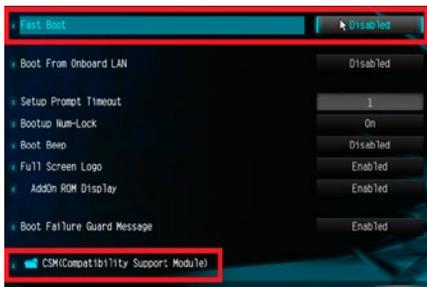
「Boot」タブでは、「CSM」を「Disable」に、「Fast Boot」を「Fast」 or 「Ultra Fast」にすると、OS の起動が高速になります。「UltraFast」の場合、高速すぎて起動時に DEL を押して再度 UEFI に入るのが困難になりますのでご注意ください。
