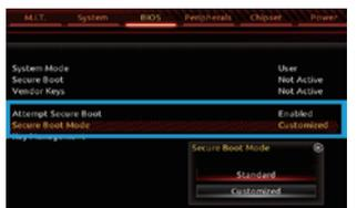
「CSM Support」のさらに下の「Secure Boot」に入り、「Attempt Secure Boot」を「Enable」に、下の「Secure Boot Mode」を「Standard」にします。
