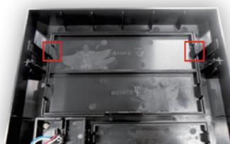
パネルを外したら、触りやすい側の爪を内側に曲げながら、5インチベイのカバーを外側に押し出します。カバーが外れたらパネルを戻します。爪を強く押すと折れる事がありますのでご注意ください。
