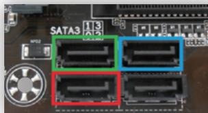
起動用のHDD/SSDはSATA3\_0(赤枠)、光学ドライブはSATA3\_3(青枠)に接続します。別途HDD/SSDを増設した場合は、SATA3\_1(緑枠)に接続します。
