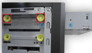
赤枠のロックを少し引き、光学ドライブ前面から挿入します。ドライブのネジ穴がロックの真下(青枠)に来たら、ロックを押ししてドライブを固定します。
