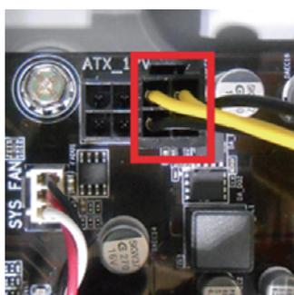
マザーボード用8ピンに電源の4ピンケーブルを接続する時は、右側の4ピンに接続してください。
