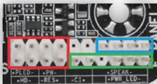
赤枠部分にフロントパネル用ケーブルを、青枠部分にBEEPスピーカーを接続します。緑枠の部分は使用しません。
