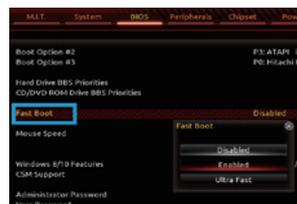
「Bios」タブの「Fast Boot」を「Enable」 or 「Ultra Fast」にすると、OSの起動が高速になります。「Ultra Fast」の場合、高速すぎて起動時にDELを押して再度UEFIに入るのが困難になりますのでご注意ください。
