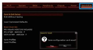
光学ドライブのイジェクトボタンを押してトレイをだし、Windows 10のディスクをセットしたら、「Save & Exit」タブの「Save & Exit Setup」を選択し、「Yes」を押して設定保存&再起動をします。
