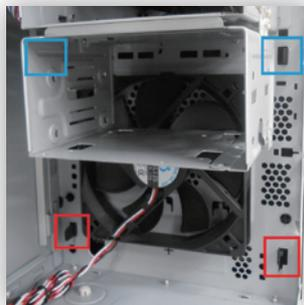
パネルを引きながら、赤枠のロックを外側に、赤枠が外れたら青色のロックを内側に押し、下の方から少しずつパネルを外します。
