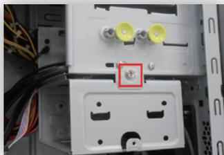
赤枠のネジを外し、ベイを取り出してHDDを取付けます。先にケーブルをまとめるため、まだ戻さないでください
