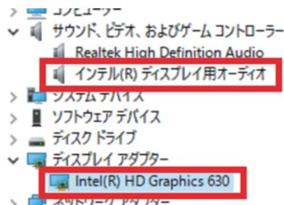
OSインストール後、ディスクをマザーボードに付属のドライバディスクに入れ替え、メニュー画面の「Xpress Install」をクリックしてドライバをインストールします。完了のメッセージが表示されたら、PCを一度再起動します。ディスクのバージョンによっては、この時点でIntelのグラフィック・サウンドドライバがインストールされませんので、再起動後にLANを接続して数分お待ちください。マウスカーソルを画面左下に合わせ、マウスを右クリック→デバイスマネージャを開き、「サウンド、ビデオ、およびゲームコントローラー」「ディスプレイアダプター」の項目にインテル(Intel)ドライバが表示されればインストールは完了です。
