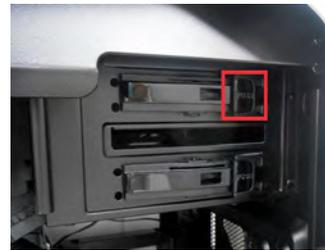
カバーを外したら、**赤枠**部分の「PUSH」と書かれているロックを引いて外し、外側からBDドライブを押し込みます。
