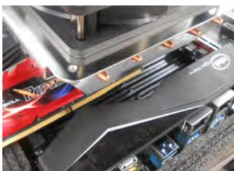
クーラーの下になるメモリスロットは、この隙間を通して入れ、内部でメモリを立てて挿しこみます。スロットに挿す時は、両端を同時に押し込むようにしてください。
