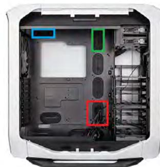
標準では**赤枠**の位置から各種ケーブルがケース内に引き込まれています。USB2.0、AUDIO、フロントパネル用ケーブルを残し、ファンコントローラやUSB3.0のケーブルは裏側に出しましょう。なお、背面ファンとCPUクーラーのケーブルは**青枠**、増設ファンのケーブルは**緑枠**から裏側に出します。
