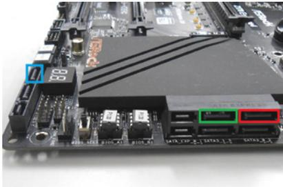
起動用の HDD/SSD は Port0 (赤枠)、光学ドライブは Port5 (青枠) を推奨します。
