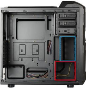
3.5 インチ HDD は赤枠、2.5 インチ HDD/SSD は青枠部分に取り付けます。
