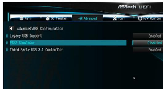
Intel 100 シリーズマザーボードのUSBはxHCIのため、Windows 7のインストール時にUSBの操作ができなくなります。PS/2接続のキーボードやマウスを使用するか、UEFI内の「Advanced」→「USB Configuration」にある「PS/2 Simulator」もしくは「Port 60/64 Emulation」(UEFIバージョンによりいずれかの表記になります)を「Enable」に設定して下さい。「Enable」時はUSBの速度が低下する事がありますので、OSやドライバインストール後は「Disable」に戻すことをお勧めします。
