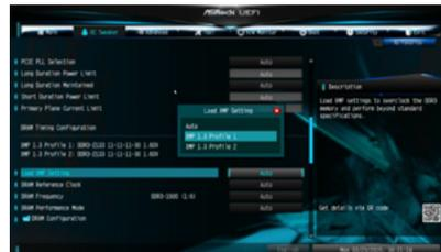
本モデルに付属のメモリは、UEFI で XMP 設定を呼び出すことで、PC3-17000 (DDR3-2133) で動作します。「OC Tweaker」タブ内の「Load XMP Setting」を「XMP 1.3 Profile 1」に変更して下さい。
