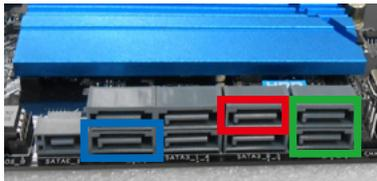
起動用の HDD/SSD は Port0 (赤枠)、光学ドライブは Port5 (青枠) を推奨します。SATA Express 用の小さいコネクタと ASMEDIA 製 SATA3.0 (緑枠) は、通常は使用しません。
