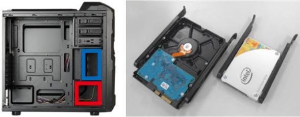
3.5 インチ HDD は赤枠、2.5 インチ HDD/SSD は青枠部分に取り付けます。ドライブの取付にはレールを使用するため、ネジは不要です。
