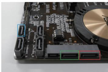
起動用の HDD/SSD は ATA6G\_1 (赤枠)、光学ドライブは ATA6G\_6 (青枠) に接続します。別途 HDD/SSD を追加した場合は、SATA6G\_2 (緑枠) に接続します。
