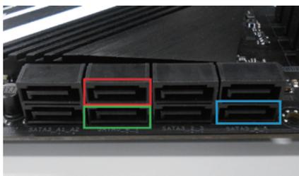
起動用のHDD/SSDはPort0(赤枠)、光学ドライブはPort5(青枠)を推奨します。
