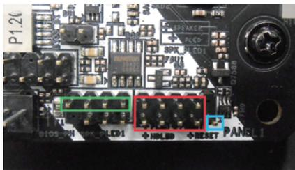
フロントパネル用ケーブルは、マザーボード右下の赤枠部分のピンに接続します。
