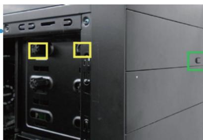
最初に前面パネルの下部(赤枠)に手を入れ、パネルを引きながら外します。
