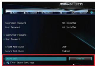
「Security」タブの「Secure Boot」を「Enable」にすると、下にKey状態が表示されます。「Clear Secure Boot Keys」になるようにしてください。
