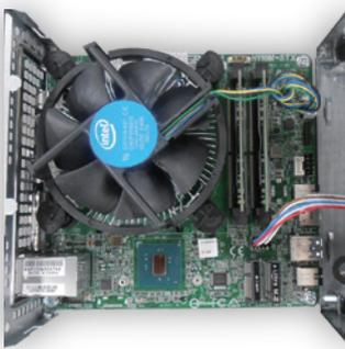
⑧ 前面パネル用ケーブルをつけ直し、元通りに押し込み、ネジ止めしてください。押し込む時は、前面ケーブルをケースの奥に挟まない様にご確認ください。
