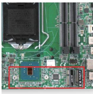
⑨ 別途 M.2 SSD を用意する方は、PCI-E 接続の製品をお選びください。SATA 製品は非対応です。カードのサイズは 2242・2280 のみ対応です。
