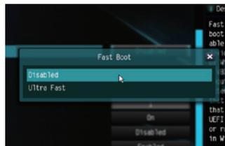
「Boot」タブでは、「CSM」を「Disable」に、「Fast Boot」を「Ultra Fast」にすると、OSの起動が高速になります。「UltraFast」の場合、高速すぎて起動時にDELを押して再度UEFIに入るのが困難になりますのでご注意ください。
