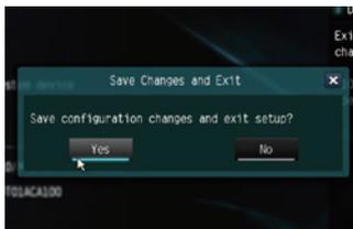
その他設定はデフォルトのままです。DVDドライブにOSのディスクをセットしたら、「Exit」の「Save Changes and Exit」で「Yes」をクリックすれば、設定を保存して再起動します。
