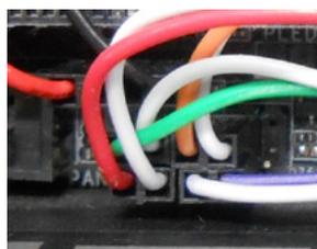
赤枠部分にBEEPスピーカーを、青枠部分はフロントパネル用ケーブルを配線します。
