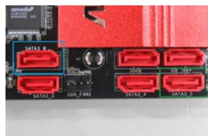
起動用のHDD/SSDはSATA3\_0 (青枠)、光学ドライブはSATA3\_5 (緑枠)を推奨します。
